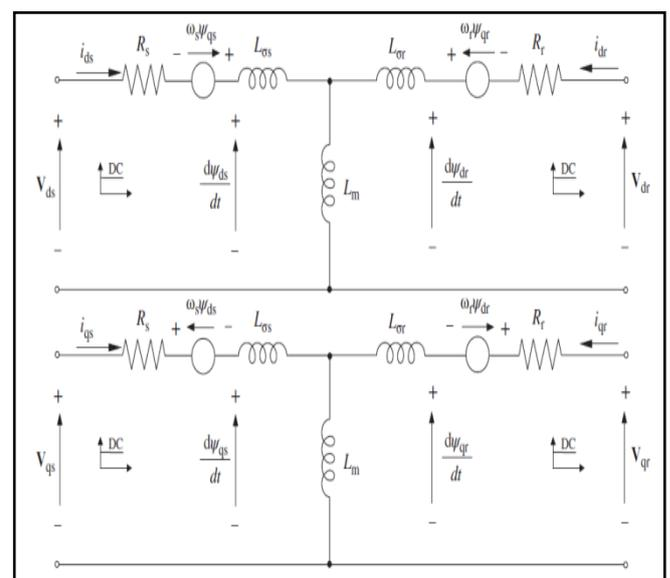
**Fig -1:** Model of the DFIM in dq reference frame.
