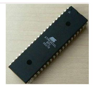
Figure 2 : Micro-controller: AVR At mega32
